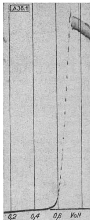
Bild 1 Polarographische Schwefelstufe in Pyridin-haltiger Lösung
