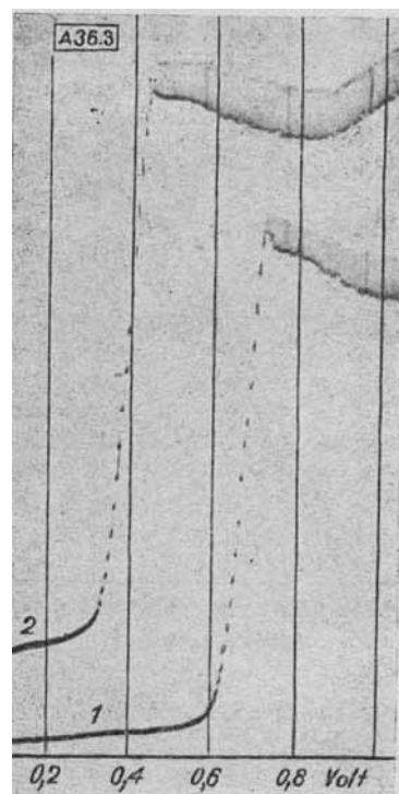
Bild 3 Polarogramm 1: Schwefelstufe in Pyridin-haltiger Lösung Polarogramm 2: die gleiche Stufe nach Zusatz der molaren Menge Mercaptobenzothiazol
